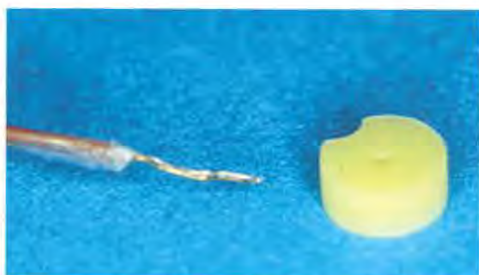
Fig. 4 - La termocoppia, posta accanto ad uno stop di gomma, per evidenziarne le dimensioni.
