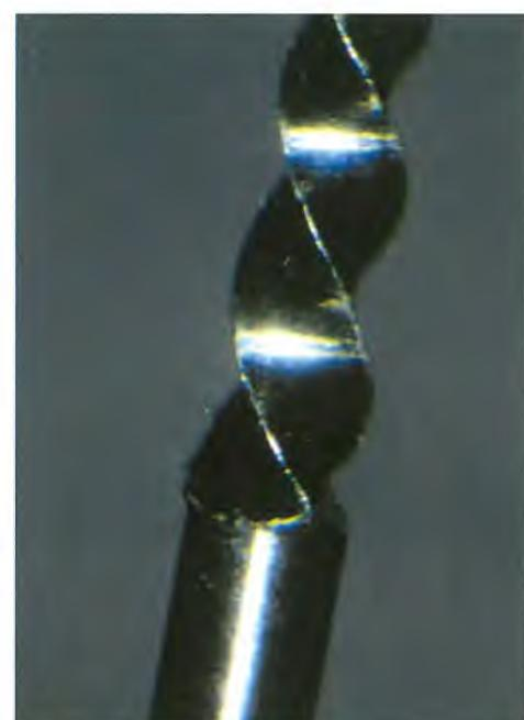
Fig. 4 - Dettaglio della parte lavorante della lima nella zona prossima al gambo.
